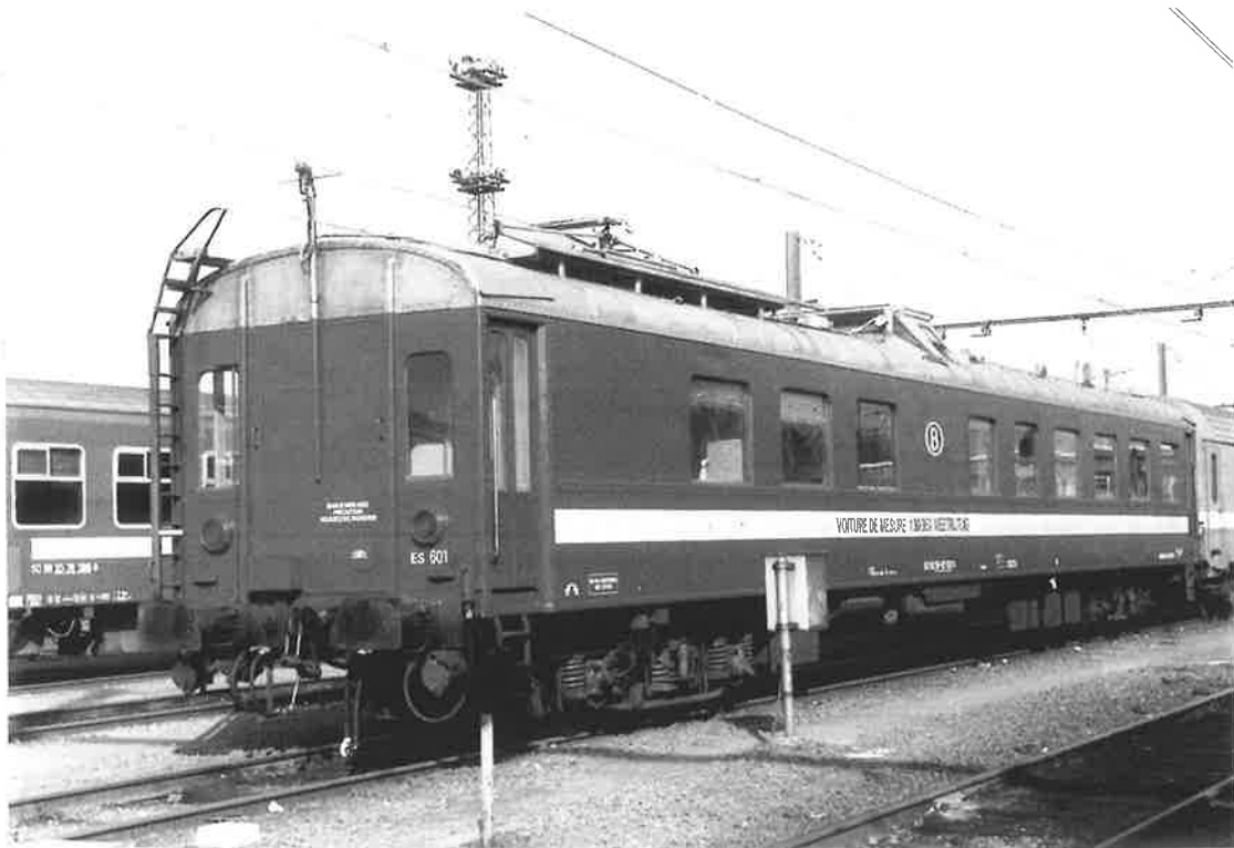
La voiture de mesures ES 601, toujours vaillante, à FSR le 07/03/02 : l'on remarque la disposition des portes typique des remorques intermédiaires des AM 35. A noter que la partie avant de la rame (1503 + voiture 801) a été décrochée et mise à l'abri des tagueurs dans l'atelier. Photo G.B.
